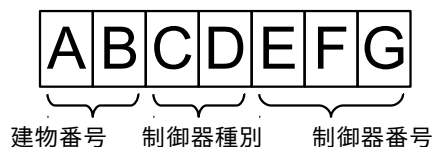
図 8.2 BACnet Device ID 付与の規則
